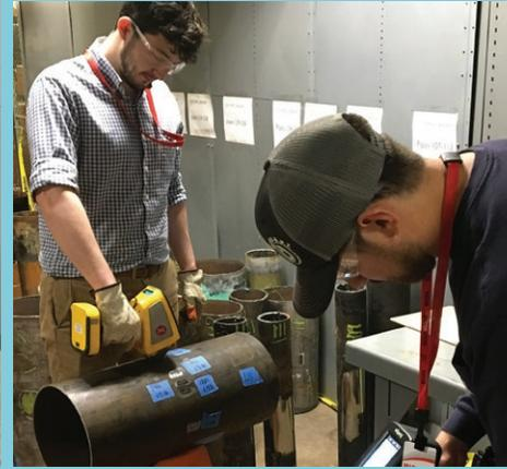
*Los miembros del equipo del proyecto primero probaron en laboratorio las muestras para determinar el límite elástico, la fuerza de tracción final, la composición y las propiedades químicas del acero, el tamaño de las partículas, la dureza y, en un subconjunto de 30 muestras, la fractura del material y la tenacidad con una prueba de Charpy.*
