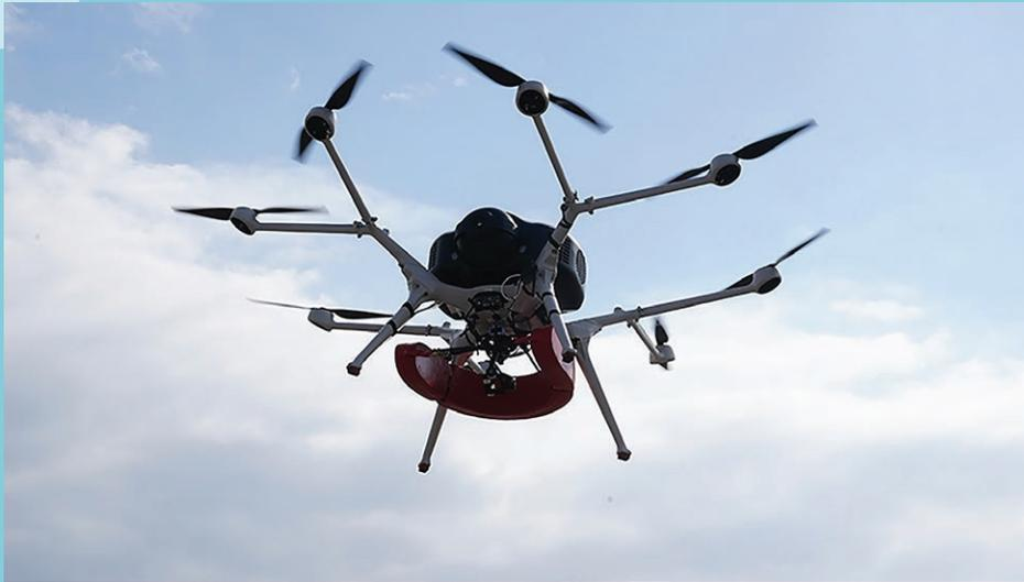
*El dron integrado de DMI pesa 21 kg, está equipado con un módem LTE y puede transportar una carga útil de 5 kg hasta por 120 minutos, aproximadamente cuatro veces el alcance de los drones eléctricos de batería. Las aplicaciones potenciales incluyen vigilancia, búsqueda y rescate, entrega de productos e inspección aérea.*
